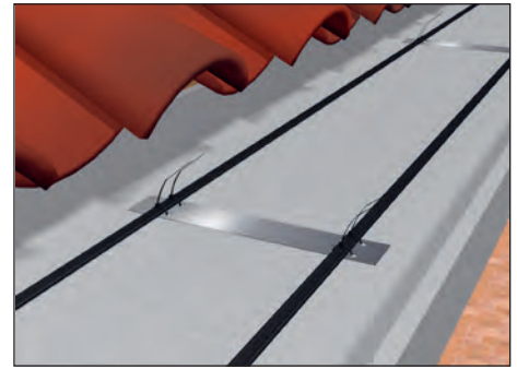
Doppelverlegung ab 150 mm Rinnenbreite oder bei besonderen örtlichen, klimatischen oder baulichen Bedingungen.
