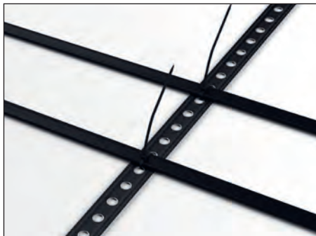
Montagelochband (Stahlblech, kunststoffummantelt) als Abstandshalter bei Mehrfachverlegung. Typ: MLB-10
