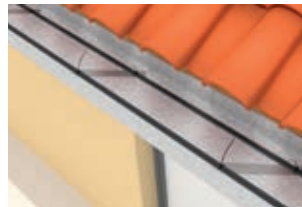
Abstandhalter bei der Doppelverlegung des Dachrinnenheizbandes.
